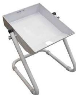
Soporte metálico para las operaciones de envasado del material seminal del sistema Pac.Co al Sac.Co., además de botella y Tubosperm. La dosificación es llevada a cabo por medio de tubos dispensadores y la correspondiente pinza.
