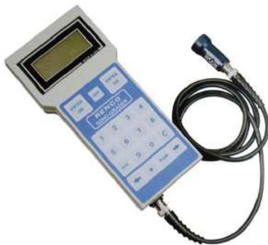
Aparato de ultrasonido para medir el espesor del tocino dorsal. Display digital para la lectura de la medición. Funciona con batería de Ni-Cd. Recargable a 220V.
