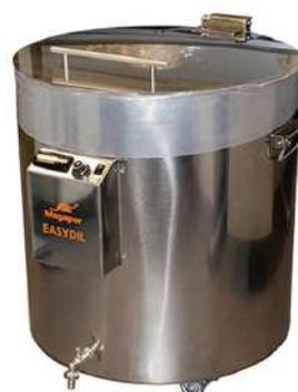
Tanque para dilución. Acero inoxidable. Capacidad de 100 litros con agitador magnético y regulación de temperatura a elección del usuario.
