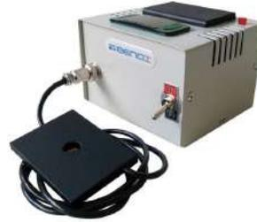
Dispone de 2 platinas térmicas. Una para mantener a temperatura el material para la observación de la muestra y otra para ubicar sobre la platina del microscopio. Diseño exclusivo Genox. Capacidad de regular la temperatura, regulada de fábrica a  $37^{\circ}\text{C}$ .
